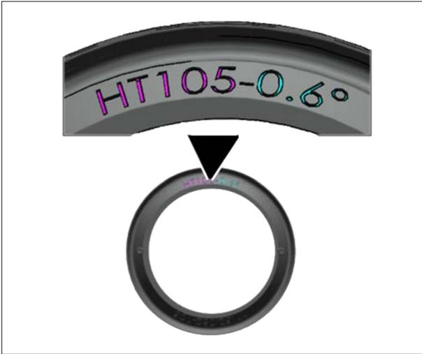
Es importante instalar correctamente la dirección dependiendo de la configuración deseada. Hay dos tipos de cazoletas para la dirección.
