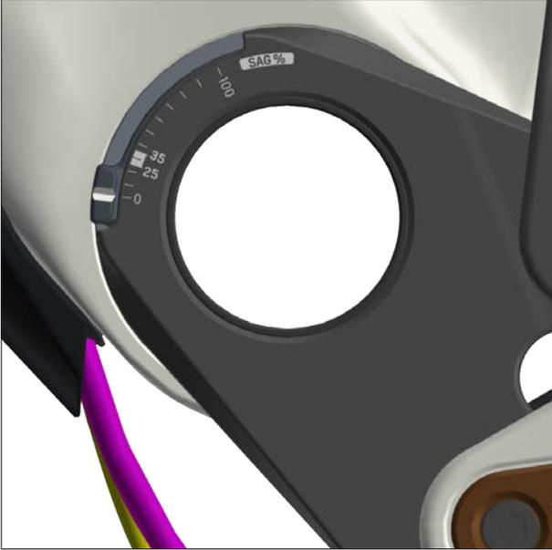
**01** Ponte el equipamiento que usas normalmente, coloca el indicador de SAG a 0 y el Tracloc en posición abierta.
